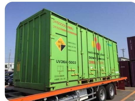
ラウンド輸送で活用する独自設計のコンテナ
